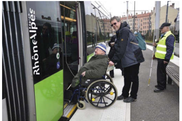
Foto 10: Lyon, voorstedelijke sneltram met lage vloer tram en drempelloos perron.
