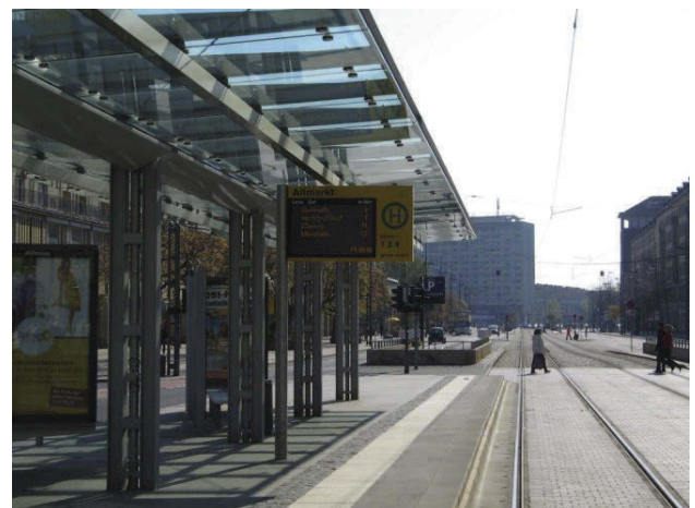
Foto 8: Dresden – Dresdner combibord, volledig verhoogde halteplaats geschikt voor zowel tram als bus.
